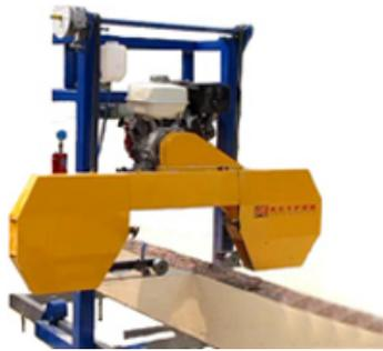
Бензиновая ленточная **пилорама Астрон-9.02beta** предназначена для **изготовления** доски, бруса, рейки, шпал и т.д.
